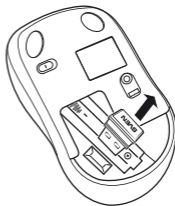
Рис. 7. Извлечение ресивера из корпуса мыши
