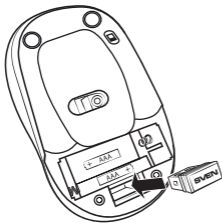
Рис. 6. Установка ресивера в корпус мыши
