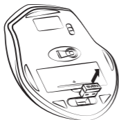
Рис. 5. Извлечение ресивера из корпуса мыши
