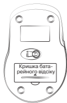
Мал. 4. Встановлення батарейок
