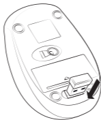
Imag. 6. Instalarea receiver-ului în carcasa mouse-ului
