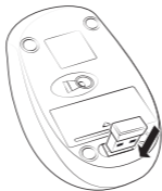
Рис. 6. Установка ресивера в корпус мыши
