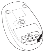
Мал. 6. Встановлення ресивера в корпус миші
