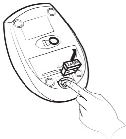
Рис. 5. Извлечение ресивера из корпуса мыши
