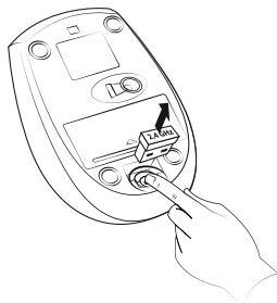
Рис. 5. Извлечение ресивера из корпуса мыши
