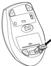
Imag. 6. Instalarea receptorului în carcasa mouse-ului
