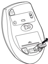
Imag. 7. Extragerea receptorului din carcasa mouse-ului
