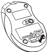
Imag. 7. Instalarea receiver-ului în carcasa mouse-ului
