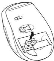
Imag. 7. Extragerea receptorului din carcasa mouse-ului
