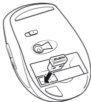
Imag. 6. Instalarea receptorului în carcasa mouse-ului
