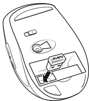
Рис. 6. Установка ресивера в корпус мыши
