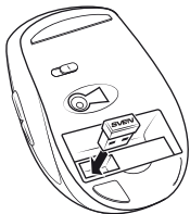
Мал. 6. Встановлення ресивера в корпус миші
