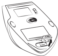
5-сурет. Ресиверді тінтеуір корпусынан шығарып алу
