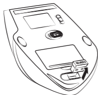
Рис. 5. Извлечение ресивера из корпуса мыши
