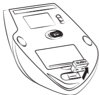
Мал. 5. Виймання ресивера з корпусу миші
