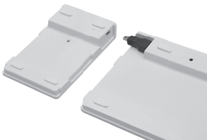
Подключение цифрового поля к клавиатуре через переходник «USB - mini USB»
