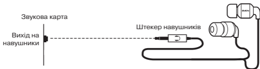
Мал. 1. Схема підключення
