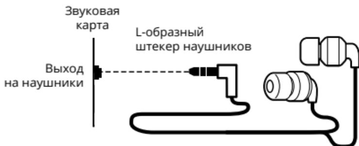
Рис. 1. Схема подключения
