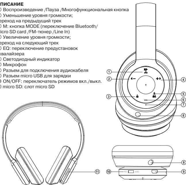
Рис. 1. Устройство наушников
